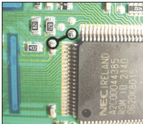
Рисунок 3. Точки установки перемычки
