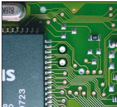
Рисунок 27. Точки программирования BOSCH M1.5.4, M1.5.4N
